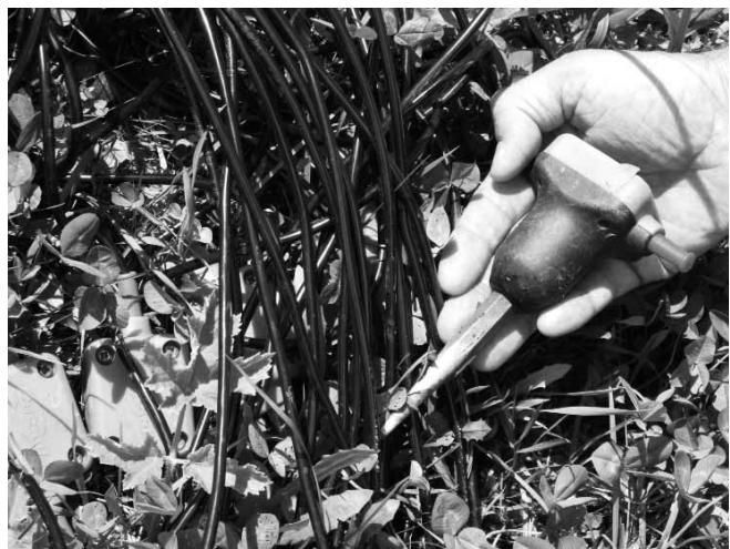
Aufnahmeseite: Messkabel mit Geophongruppe
