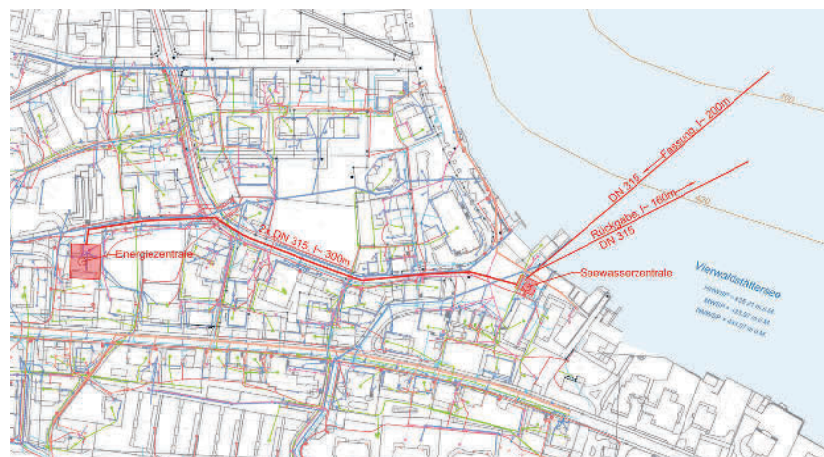
Übersichtsplan Seewasserzentrale & Energiezentrale (Stand Vorprojekt EWN 2023)
