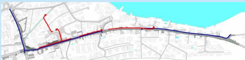
Ersatz Wasserleitung (blau) und neue Regenwasserleitung (rot)
