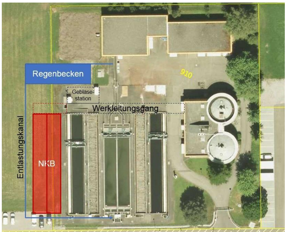
Abbildung 15: Konzeptskizze Entlastungskanal inkl. Regenbecken. Rot: neue Nachklärung, Verlängerung Werkleitungsgang. Blau: Entlastungskanal und Regenbecken. Schwarz: bestehende Gebläsestation und Werkleitungsgang.
