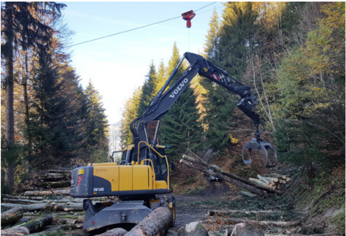
Einsatz Bagger mit Seilkrananlage
