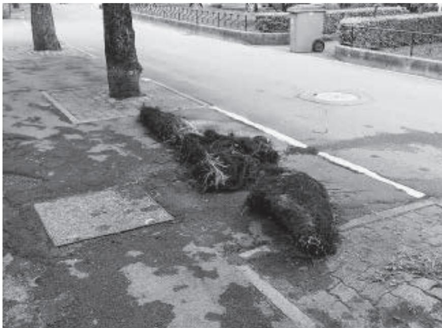
**Aus Regenabwasserkanal entnommener, zersägter Wurzelzopf**
