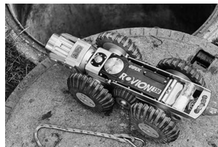
Kanalfernsehroboter, ca. 30 cm lang
